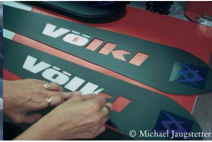
Einsetzen des Völkl-Schriftzuges in den Belag
